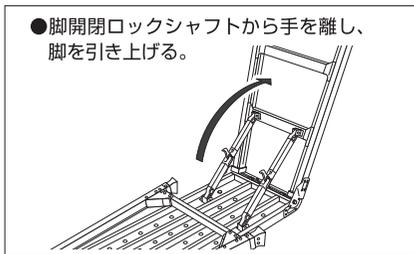
※プレスのロックヒンジ部がカチッと音がするまで引き上げてロックする。
